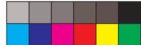
Abb. 37: Vorlage aus Graukeil und Buntfarben (Farben verschmutzt, Tonwerte zu dunkel)
