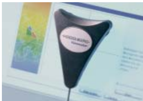
Abb. 20: ICC-Profile können für alle Geräte erstellt werden. Damit sie den aktuellen Gerätezustand beschreiben, müssen die Geräte regelmäßig kalibriert werden.
