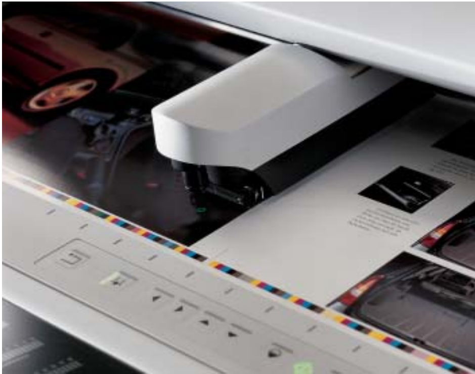
Zur objektiven Farbmessung werden Spektralfotometer eingesetzt.
