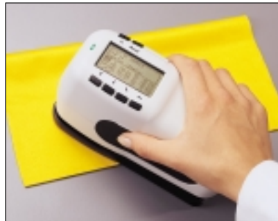
Ein portables Spektralphotometer mit Kugelgeometrie mißt die Farbe von Textilproben oder anderer Materialien, bei denen das Erscheinungsbild wesentlich für die Akzeptanz des Kunden ist.
