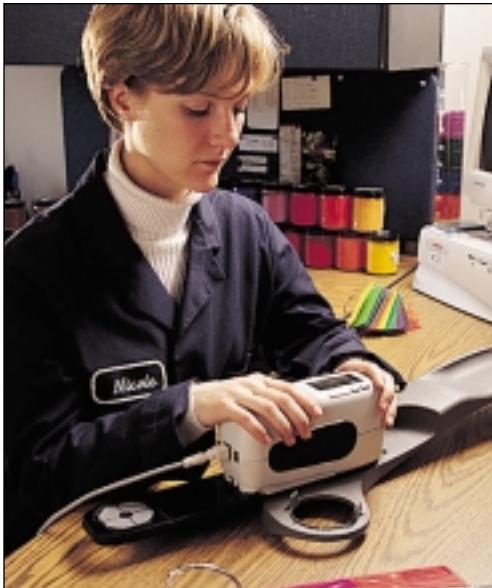
Ein Spektralphotometer ist Grundlage für die Farbrezepturierung verschiedener Produkte wie Kunststoffe, Farben, Druckfarben, Textilien und Lacke.
