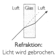
Refraktion eines (monochromatischen) Lichtstrahls an einer planparallelen Platte.
